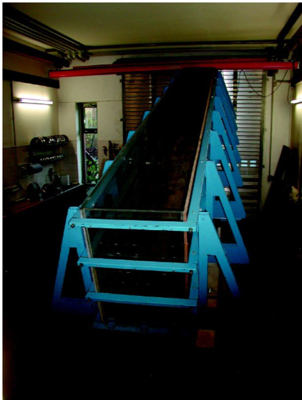
Bild 6 Kipprinne, Länge 6,0 m
