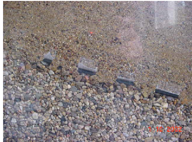
Bild 3.2 Dichtungsbahnstreifen in der Grenzfläche
